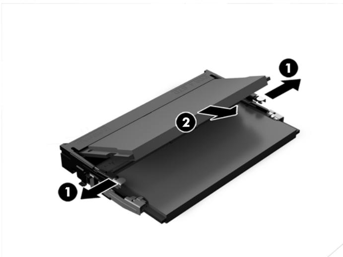
3. Insira o novo módulo de memória para dentro do slot em um ângulo de aproximadamente 30° (1) e então pressione o módulo de memória (2) no slot de forma que as travas se encaixem corretamente.
