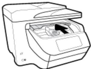
2. Otevřete vnitřní kryt zvednutím a posunutím směrem k sobě.
