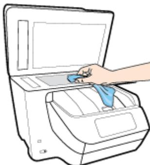
**UPOZORNĚNÍ!** K čištění skla skeneru používejte pouze čisticí prostředek na sklo. Nepoužívejte čističe, které obsahují abrazivní částice, aceton, benzen a chlorid uhličitý, které mohou sklo skeneru poškodit. Nepoužívejte ani isopropylalkohol, protože může na skle skeneru zanechat šmouhy.
