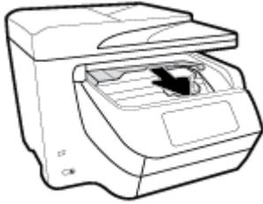
6. Vyměňte zásobník 1 vytažením z tiskárny.
