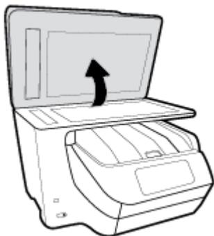
2. Očistěte sklo skeneru a spodní stranu víka měkkým hadříkem, který nepouští vlákna, navlhčeným jemným prostředkem na čištění skla.
