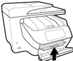
11. Klappen Sie die Duplex-Klappe hoch, schieben Sie diese nach hinten und schließen Sie die Duplex-Klappe.
