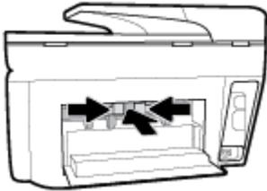
7. Schließen Sie die hintere Zugangsklappe.
