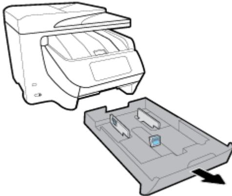
2. Schieben Sie die Papierführungen innerhalb des Faches bis zum Anschlag nach außen.
