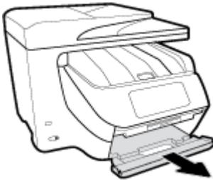
3. Entfernen Sie das eingeklemmte Papier.
