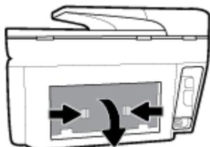
3. Entfernen Sie das eingeklemmte Papier.
