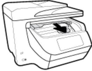
6. Entfernen Sie Fach 1, indem Sie es aus dem Drucker herausziehen.
