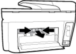
5. Entfernen Sie das eingeklemmte Papier.
