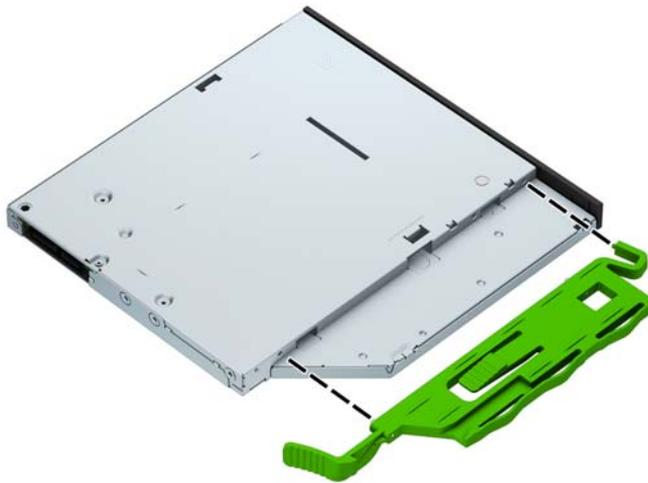
9. Faites glisser l'unité optique à travers le châssis avant (1) jusqu'au fond du compartiment jusqu'à ce qu'elle s'emboîte, puis branchez le câble d'alimentation (2) et le câble de données (3) à l'arrière de l'unité.
