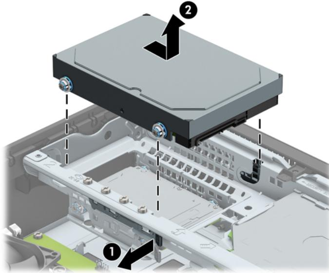
9. 若要安裝硬碟，您必須拆下舊硬碟上的固定螺絲，用於安裝新硬碟。
