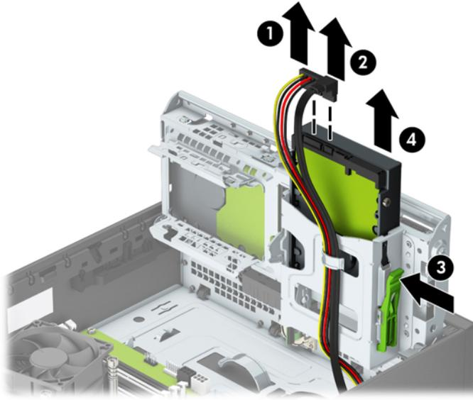
9. 若要安裝新的磁碟，請參閱[位於第 32 頁的安裝 3.5 吋次要硬碟](#)。若非安裝新的磁碟，請將磁碟機箱向下翻轉，然後裝回存取面板。
