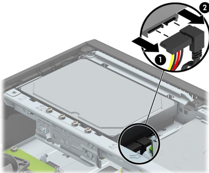
8. 將硬碟背面旁的釋放槓向外拉 (1)。將釋放槓向外拉時，同時把硬碟往後滑，直到無法移動為止，然後向上提起硬碟，從插槽中取出 (2)。
