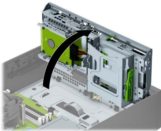
8. 拔除硬碟背面的電源線 (1) 和資料排線 (2)。
