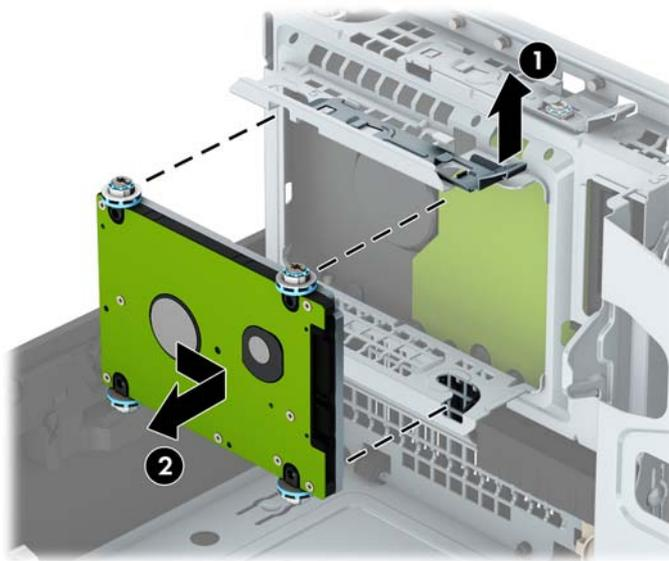
10. 若要安裝新的磁碟，請參閱[位於第 37 頁的安裝 2.5 吋硬碟](#)。若非安裝新的磁碟，請將磁碟機箱向下翻轉，然後裝回存取面板。
