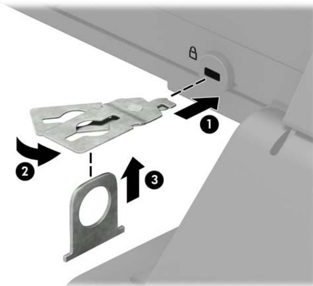
5. 將安全纜線穿過安裝在螢幕上的安全纜線導件。
