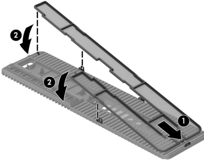
12. 若要裝回濾網存取面板，請將濾網存取面板的左側滑入主機殼 (1)，然後將濾網存取面板的右側壓到主機殼上 (2)，使其卡入定位。
