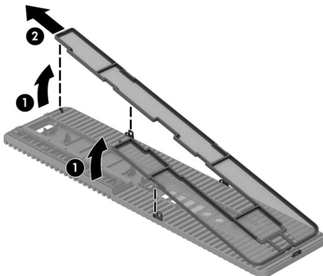
9. 使用軟刷或軟布清潔濾網存取面板上的灰塵。如果灰塵過厚，則使用清水沖洗濾網存取面板。
