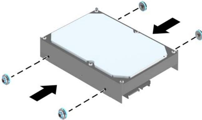
10. 將固定螺絲與機殼磁碟機箱上的插槽對齊，接著將硬碟壓入插槽中，然後向前滑動，直到無法移動並鎖到定位。
