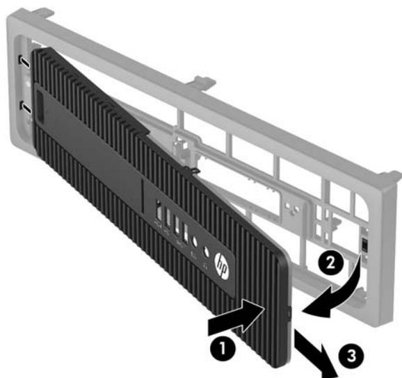
8. 若要拆下灰塵濾網，請拉起濾網兩端 (1)，然後將濾網拉起使其脫離濾網存取面板 (2)。
