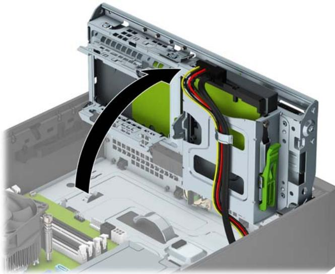
8. 拔除硬碟背面的電源線 (1) 和資料排線 (2)。壓下磁碟機箱側面的釋放門 (3)，然後將磁碟從磁碟插槽滑出 (4)。
