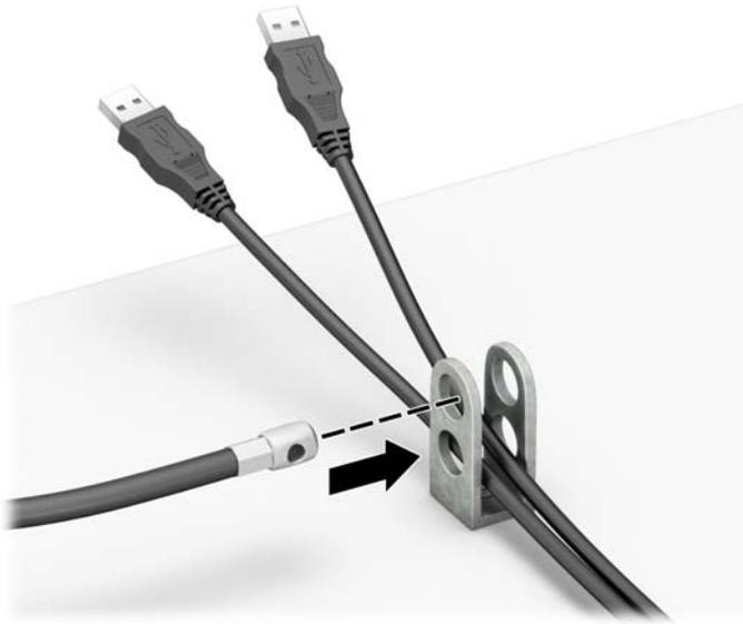
8. 使用隨附的螺絲 (1)，將鎖鎖入機殼。將安全纜線尾端的插銷插入鎖中 (2)，然後按下按鈕上鎖 (3)。使用隨附的鑰匙即可開鎖。
