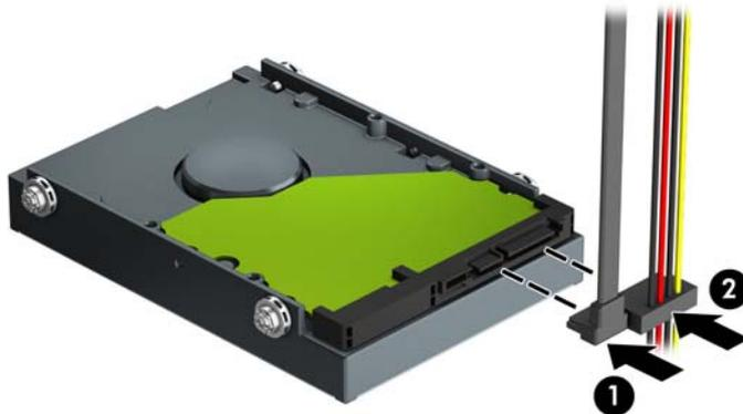
10. Jika Anda memasang drive baru, sambungkan ujung kabel data lainnya ke konektor papan sistem yang sesuai.
