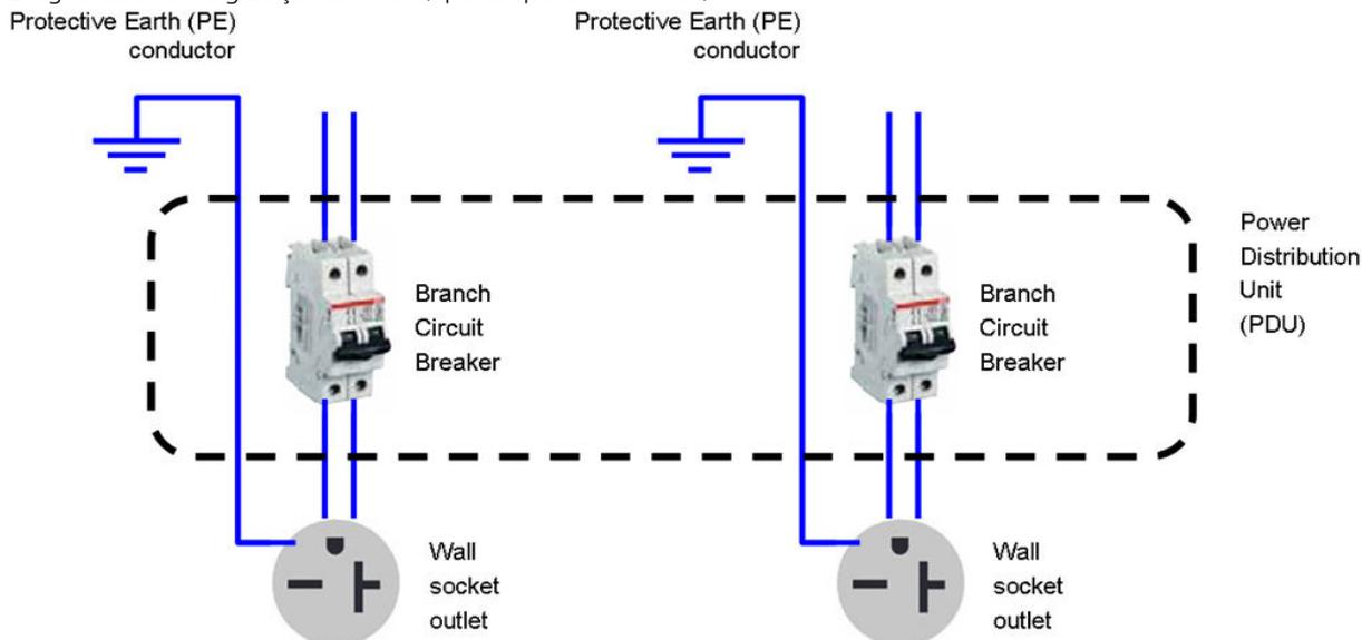
**NOTA:** A PDU (unidade de distribuição de energia) deve ser adequada para atender aos requisitos de alimentação da impressora e deve estar de acordo com as exigências do código elétrico da jurisdição local do país em que o equipamento é instalado.
