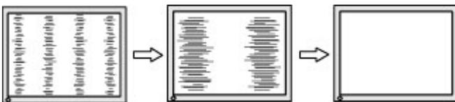
3. Après avoir ajusté l'Horloge, si des scintillements, tremblements ou barres apparaissent à l'écran, procédez au réglage de la Phase.
