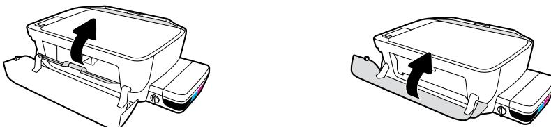
Cierre la puerta de acceso al cabezal de impresión y después cierre la puerta delantera.
