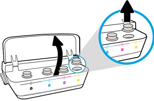
Abra a tampa do tanque de tinta. Remova o tampão do tanque amarelo.
