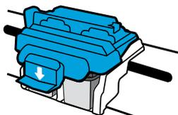
**IMPORTANTE!** Mantenha fechada a trava azul do carro após a instalação do cabeçote de impressão.
