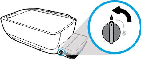
É necessário destravar a válvula (posição vertical) antes de imprimir para que a tinta possa fluir.
