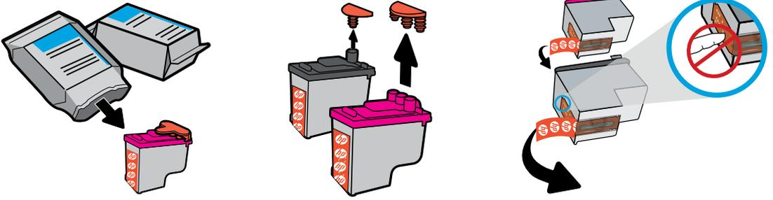
Remova os tampões da parte superior dos cabeçotes e remova a fita dos contatos utilizando a aba.
