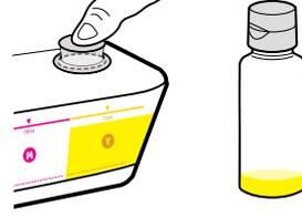
Segure o frasco amarelo no bocal do tanque e escoe a tinta. Recoloque o tampão e pressione-o com firmeza para fechar.
