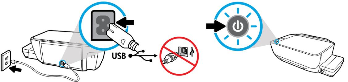
Conecte o cabo de força e ligue o equipamento. Não conecte o cabo USB até que isso seja solicitado durante a instalação do software.
