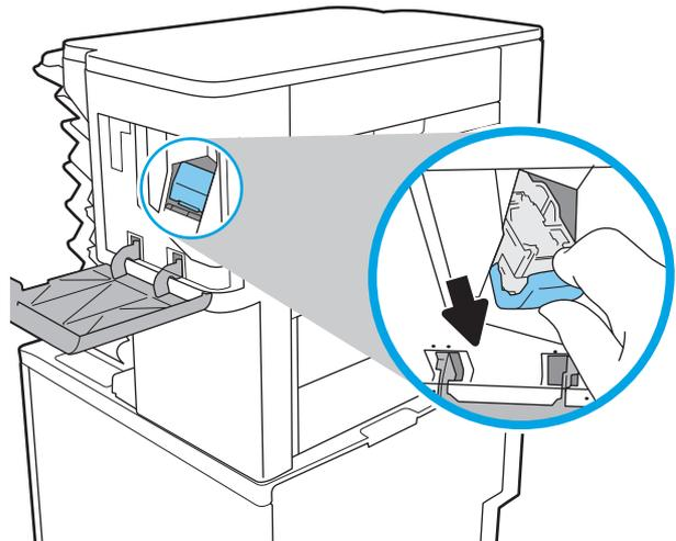
3. Inserte el nuevo cartucho de grapas en la grapadora y empuje la pestaña coloreada hasta que encaje en su posición.
