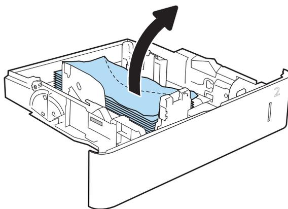
3. Retire los sobres de los rodillos de alimentación situados en el interior de la impresora.
