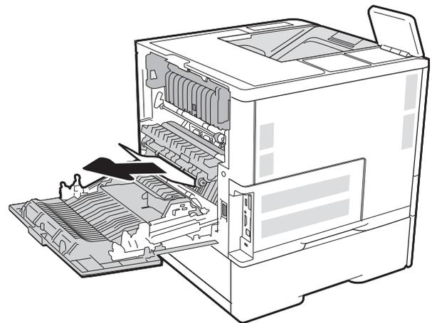
6. Retire el fusor sujetando las dos palancas laterales y tirando de él hasta extraerlo de la impresora.
