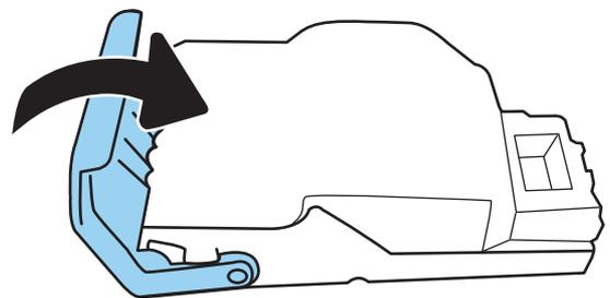
6. Inserte el cartucho de grapas en la grapadora y empuje la pestaña coloreada hasta que encaje en su posición.
