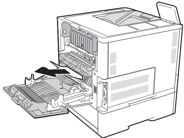
3. Retire el fusor sujetando las dos palancas laterales y tirando de él hasta extraerlo de la impresora.
