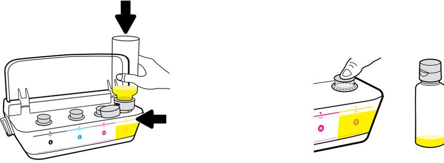
Segure o frasco amarelo no bocal do tanque e escoe a tinta. Recoloque o tampão e pressione-o com firmeza para fechar.
