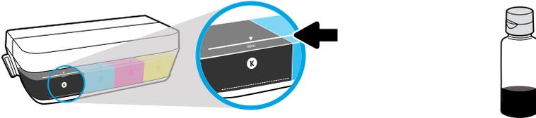
Não ultrapasse a linha máxima de tinta ao reabastecer. Durante o reabastecimento, pode ser que sobre tinta.
