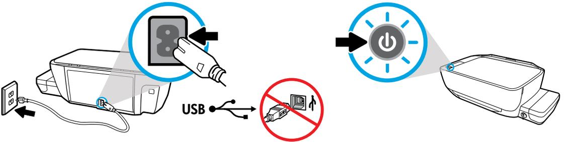
Conecte o cabo de força e ligue o equipamento. Não conecte o cabo USB até que isso seja solicitado durante a instalação do software.
