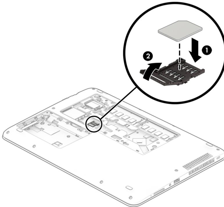
Per rimuovere una scheda SIM, ruotare la cerniera del connettore SIM verso l'alto, quindi rimuovere la scheda SIM dal connettore.
