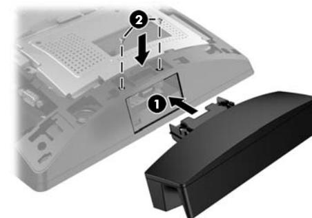
4. Alignez les taquets sur le couvercle de la tête d'affichage avec les encoches sur la tête d'affichage. Placez le couvercle sur la tête d'affichage et ensuite glissez-le vers le bas jusqu'à ce qu'il se fixe en place.
