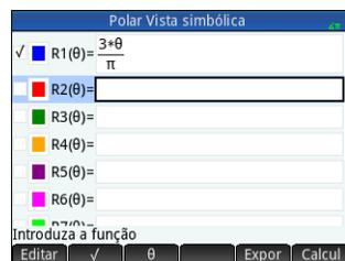
**Vista de desenho** Prima **Plot** para aceder à vista de Desenho e ver os gráficos das equações selecionadas na vista Simbólica. A funcionalidade aqui é igual à da vista de Desenho da aplicação Função, com a exceção de que aqui não existem funções Funç.
