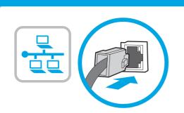
EN If you are connecting to a network, connect the network cable now. CAUTION: Do not connect the USB cable now. NOTE: The cables are not included with the printer. אם אתה מתחבר לרשת, חבר כעת את כבל הרשת. זהירות: אין לחבר בשלב זה את כבל ה-USB. הערה: הכבלים אינם מצורפים למדפסת.
