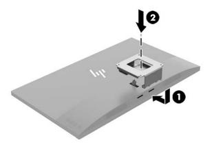
4. Per collegare il monitor a un braccio snodabile o altro dispositivo di montaggio, inserire quattro viti di montaggio nei fori del dispositivo di montaggio e nei fori sulla staffa VESA.
