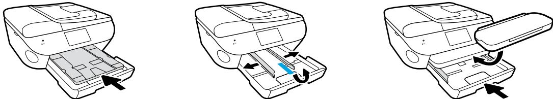
Empuje la bandeja de fotografías hacia dentro. Deslice las guías hacia fuera.
