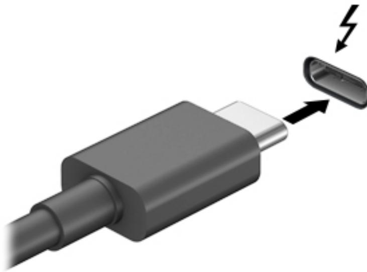
2. 将电缆的另一端连接到外接 Thunderbolt 设备。
