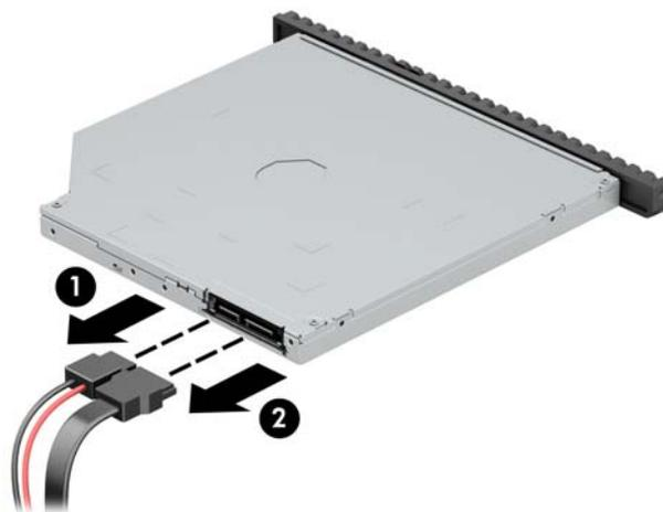
7. ドライブの背面右側にある緑色のリリースラッチをドライブの中央に向けて押し(1)、ドライブを前方向にスライドさせてベイから取り出します(2)。
