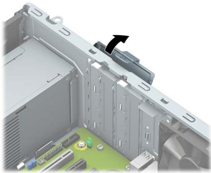
8. 新しい拡張カードを取り付ける前に、拡張スロットカバーまたは装着されている拡張カードを取り外します。
