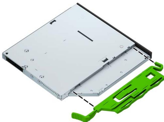
8. オプティカルドライブをフロントパネルを通してベイの奥までスライドさせ (1)、ドライブの背面にあるラッチ (2) を所定の位置に固定します。
