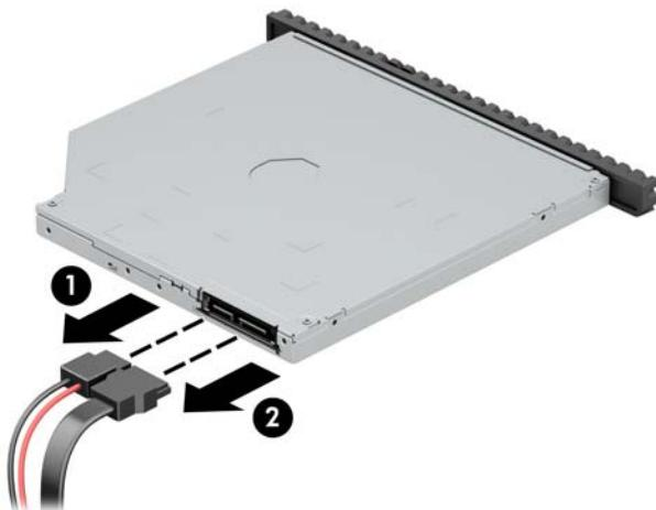
7. Gurnite zeleni zasun za otpuštanje na stražnjoj desnoj strani pogona prema sredini pogona (1), zatim povucite pogon prema naprijed i izvucite ga iz ležišta (2).
