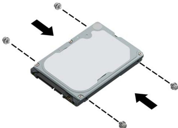
7. Poravnajte prednje vijke za postavljanje na pogonu s J-utorima sa strana ležišta pogona. Pritisnite prednji dio pogona u ležište pogona, a zatim povucite pogon prema naprijed (1). Zatim pritisnite stražnju stranu pogona prema dolje u ležište pogona (2) tako da disk sjedne na mjesto.
