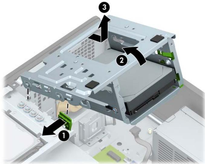
8. Pogon oslobođite povlačenjem jezičca za otpuštanje u smjeru suprotnom od pogona (1) te izvlačenjem pogona iz ležišta (2).
