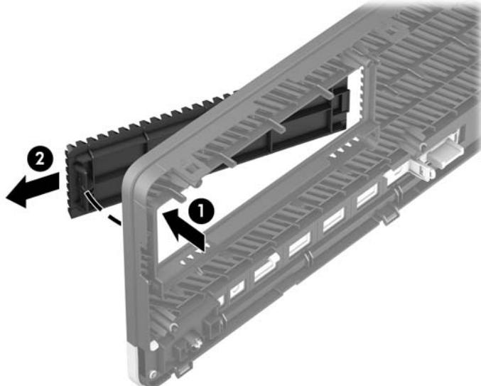
Da biste uklonili masku okvira tankog optičkog pogona, pritisnite prema unutra jezičac na desnoj strani maske (1), a zatim zarotirajte masku od prednjeg okvira (2) i izvucite lijevu stranu maske iz utora na prednjem okviru (3).
