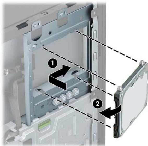
8. Priključite kabel za napajanje (1) i podatkovni kabel (2) na stražnju stranu tvrdog diska.
