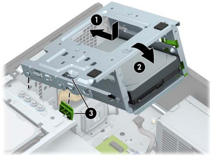
11. Priklučite kabel napajanja i podatkovni kabel na stražnju stranu pogona u kavezu tvrdog diska.
