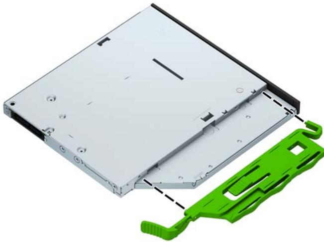
9. Schieben Sie das optische Laufwerk durch die Frontblende (1) vollständig in den Schacht hinein, bis der grüne Schieber auf dem Gehäuserahmen einrastet (2).
