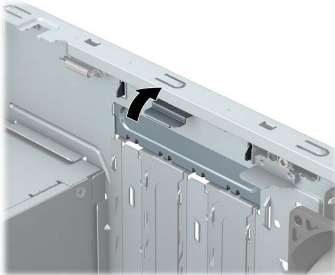
7. Localize o correto slot de expansão vazio na placa do sistema e o correspondente slot de expansão na parte traseira do chassi do computador.
