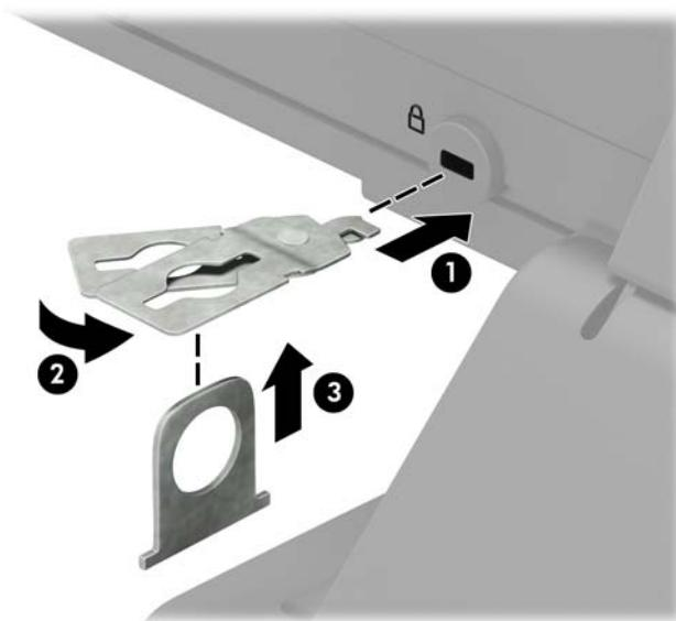
5. 将安全保护缆锁穿过安装在显示器上的安全保护导片。
