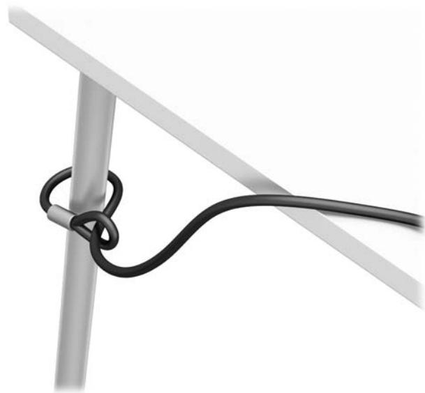
3. 将安全保护缆锁穿过安全保护缆锁扣件。
