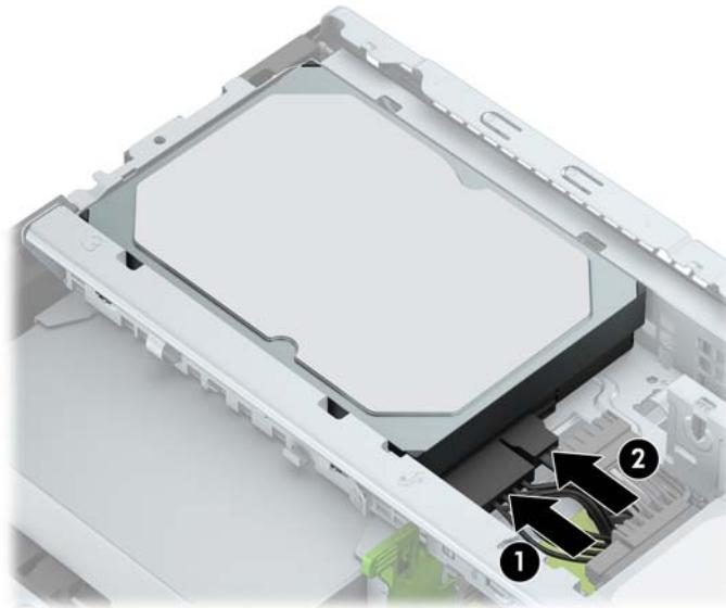
10. 如果要安装新驱动器, 请将数据电缆的另一端连到相应的主板连接器上。
