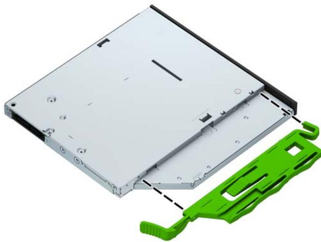
9. 将光驱通过前面板 (1) 径直推入托架中，直到绿色锁定器锁定到机箱框 (2)。
