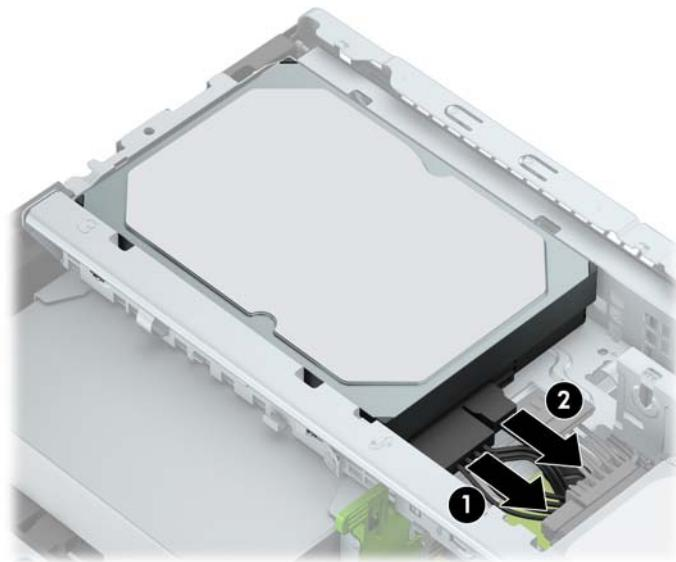
7. 将驱动器旁的锁定器向外拉 (1), 将驱动器向上旋转 (2), 然后将驱动器从驱动器箱中滑出 (3)。
