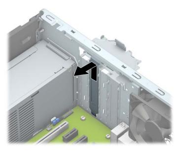
若您想拆下 PCI Express x1 卡,請握住卡的兩端並小心地前後搖動,直到接頭完全脫離插槽為止。請將擴充卡垂直向上 (1) 拉出機箱內部 (2) 以將其拆下。小心別讓其他組件刮傷介面卡。
