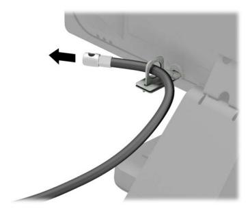
使用適合的螺絲,將配件纜線扣環安裝到桌面上(未隨附螺絲)(1),然後將配件纜線固定到扣環 基座上(2)。
