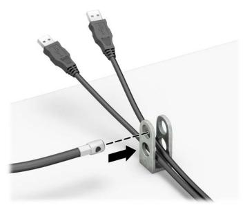
8. 使用提供的螺絲,將鎖固定在機殼上(1)。將安全纜線尾端的插銷插入鎖中(2),並按下按鈕以嚙合 鎖(3)。使用提供的鑰匙來解開鉗夾鎖。
