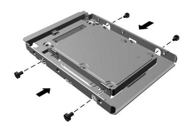
7. 將四顆固定螺絲安裝在 3.5 吋硬碟或 2.5 吋硬碟轉接機架的側面(每側各兩顆)。
