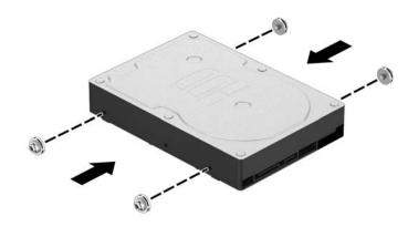
將磁碟機的一端滑入機箱(1), 然後將硬碟完全放下(2)。
