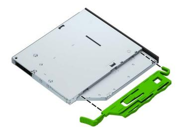
9. 將光碟機從正面機殼 (1) 一路滑進插槽中,讓綠色釋放閂鎖定機座框 (2)。
