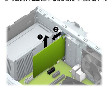
如果您要拆下 PCI Express x16 介面卡,請鬆開擴充槽背面的固定夾臂,然後小心地前後搖動 介面卡,直到接頭完全脫離插槽為止。請將擴充卡垂直向上拉出機箱內部以將其拆下。小心 別讓其他組件刮傷介面卡。
