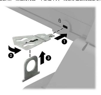
將安全纜線穿過安裝在顯示器上的安全導片。
