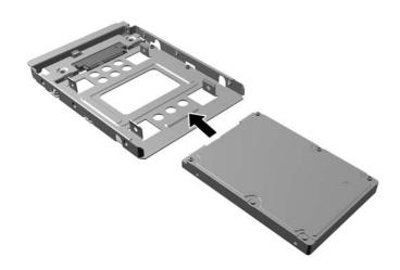
將磁碟機固定在擴充插槽轉接器支架上,方法是,將四個黑色的 M3 轉接器支架螺絲穿過支 架的側邊,安裝到磁碟機中。
