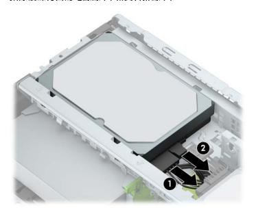
7. 往外拉動磁碟機旁的釋放閂(1),將磁碟機向上轉起(2),並將磁碟機滑出機箱(3)。
