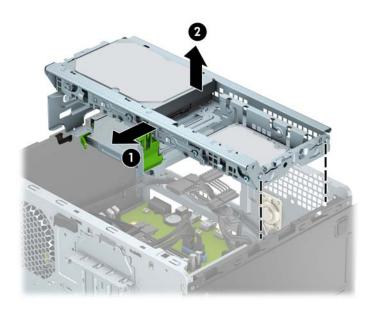
若要重新安裝磁碟機箱,請將機箱降低至提供的插槽中(1), 然後將機箱滑向電腦的正面(2)。
