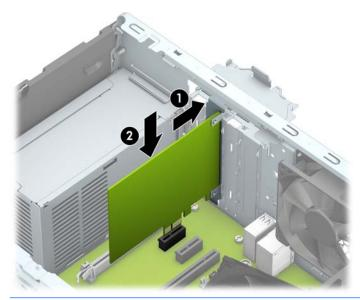
**一 附註:**安裝擴充卡時,請將卡平穩地下壓,讓整個接頭正確地插入擴充卡插槽內。
