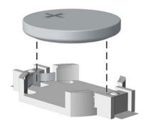
b. 將更換的電池推到定位,正極向上。電池座會自動將電池固定在適當的位置。
