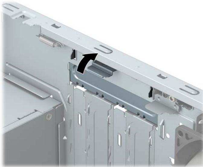
7. Cari soket ekspansi kosong yang benar pada papan sistem dan slot ekspansi yang sesuai pada bagian belakang rangka komputer.
