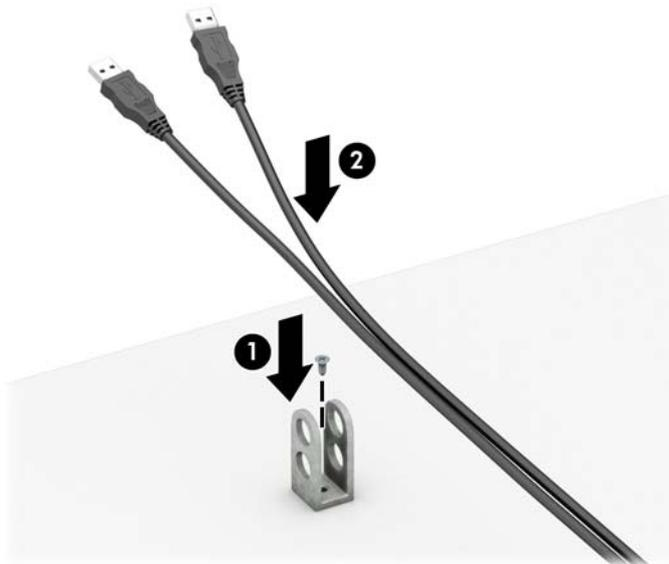
7. Masukkan kabel pengaman melalui lubang di aksesoris pengikat kabel.
