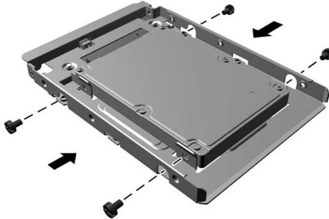
7. Pasang keempat sekrup pemasangan ke sisi drive 3,5 inci atau braket adaptor drive 2,5 inci (dua pada setiap sisi).
