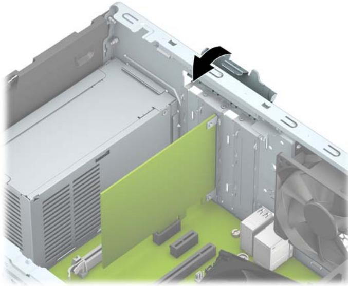
13. Bila perlu, sambungkan kabel eksternal ke kartu yang terpasang. Bila perlu, sambungkan kabel internal ke papan sistem.
