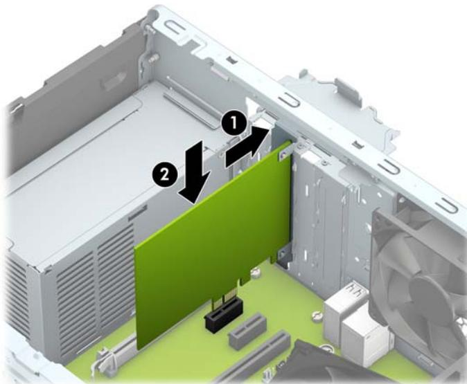
**📝 CATATAN:** Saat memasang kartu ekspansi, tekan kartu dengan kuat agar seluruh konektor terpasang dengan benar dalam soket kartu ekspansi.
