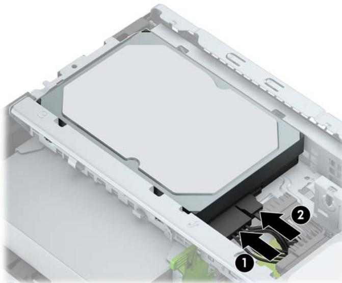
10. Jika Anda memasang drive baru, sambungkan ujung kabel data lainnya ke konektor papan sistem yang sesuai.
