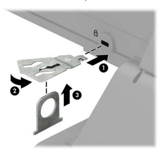
5. Deslice el cable de seguridad a través de la guía de seguridad instalada en el monitor.
