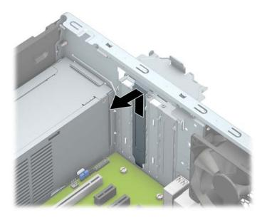
**b.** Si va a extraer una tarjeta PCI Express x1, sosténgala por cada extremo y, con cuidado, mueva la tarjeta hacia delante y hacia atrás hasta que los conectores se suelten del zócalo. Levante la tarjeta de expansión directamente hacia arriba (1) y luego extráigala del interior del chasis (2) para retirarla. Asegúrese de no rozar la tarjeta contra otros componentes.
