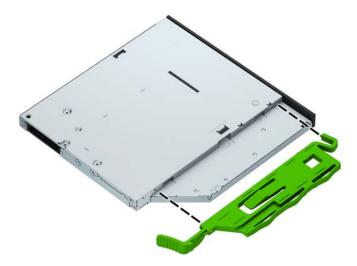
9. Deslice la unidad óptica hasta introducirla en el compartimiento a través del panel frontal (1), de forma que el pestillo verde quede encajado en el bastidor del chasis (2).
