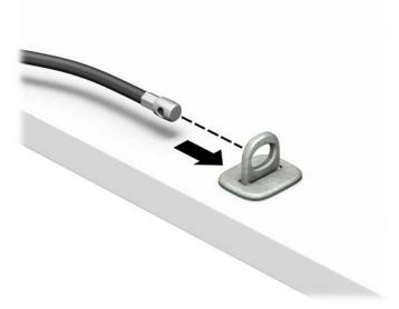
4. Retire las dos manijas del bloqueo del monitor e inserte el bloqueo en la ranura de seguridad en la parte posterior del monitor (1), junte las manijas para fijarlas en su lugar (2) y, a continuación, deslice la guía del cable a través del centro del bloqueo del monitor (3).
