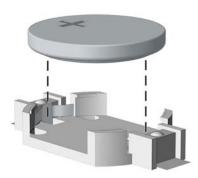
**b.** Deslice la batería de reemplazo hasta la posición adecuada, con el lado positivo hacia arriba. El compartimiento para batería fija la batería en la posición adecuada de forma automática.
