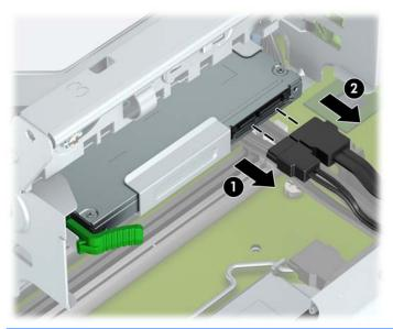
PRECAUCIÓN: Para evitar dañar el cable al retirarlo, tire de la lengüeta o del conector, pero no del cable en sí mismo.
