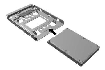
• Asegure la unidad al soporte adaptador del compartimiento instalando cuatro tornillos negros M3 del soporte del adaptador a través de los lados del soporte en la unidad.
