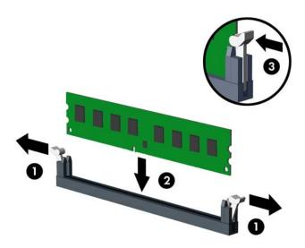
NOTA: El módulo de memoria se puede instalar de una sola manera. Haga coincidir la muesca del módulo con la lengüeta del socket de memoria.
