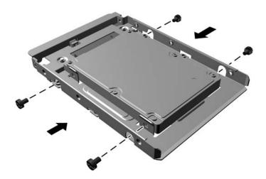
Instale los cuatro tornillos de montaje en los laterales de la unidad de 3,5 pulgadas o el soporte del adaptador de unidades de 2,5 pulgadas (dos a cada lado).
