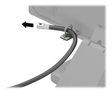
6. Conecte el cierre de cable accesorio en un escritorio usando el tornillo apropiado para su entorno (tornillo no incluido) (1) y, después, coloque los cables accesorios en la base del cierre (2).
