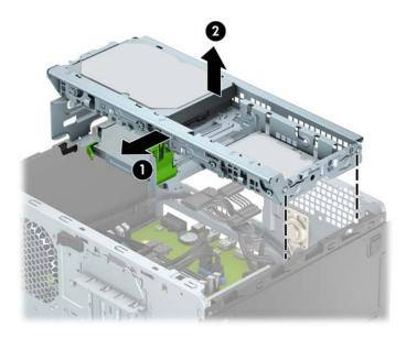
• Para volver a instalar la caja de unidades, baje la caja en las ranuras correspondientes (1) y luego deslice la caja hacia la parte frontal del equipo (2).
