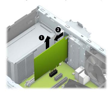
c. Si va a extraer una tarjeta PCI Express x16, aleje de la tajeta el brazo de retención ubicado en la parte trasera del socket de expansión y cuidadosamente mueva la tarjeta hacia adelante y hacia atrás hasta que los conectores sean liberados del socket. Levante la tarjeta de expansión directamente hacia arriba y luego extráigala del interior del chasis para retirarla. Asegúrese de no rozar la tarjeta contra otros componentes.
