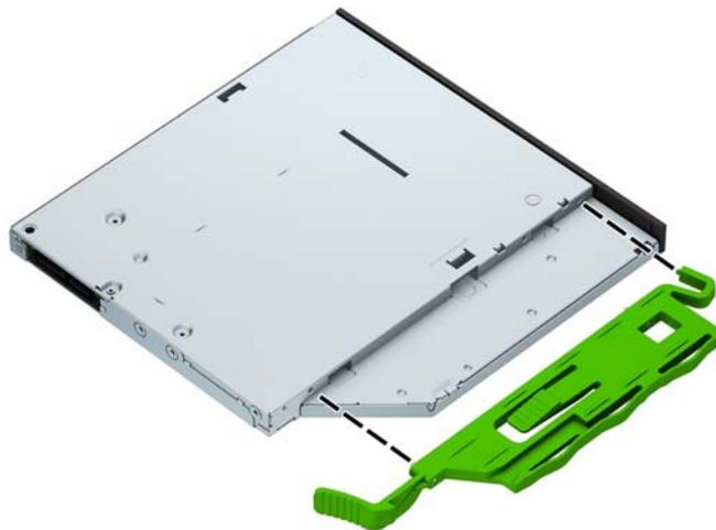
8. Schieben Sie das optische Laufwerk durch die Frontblende vollständig in den Schacht hinein (1), bis es einrastet (2).
