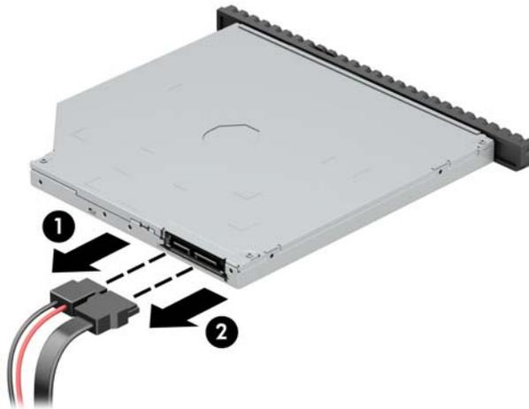
7. Drücken Sie den Freigabehebel an der Rückseite des Laufwerks (1) und schieben Sie das Laufwerk dann durch die Frontblende (2).
