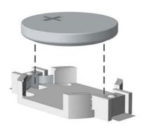
b. 交換する電池を、[+]と書かれている面を上にして正しい位置に装着します。電池は電池ホ ルダーによって自動的に正しい位置に固定されます。
