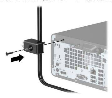
9. セキュリティ ケーブルの端の栓を差し込み (1)、ボタンを押し込んで (2) ロックを固定しま す。ロックの固定を外すには、付属の鍵を使用します。
