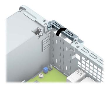
新しい拡張カードを取り付ける前に、拡張スロット カバーまたは装着されている拡張カードを取 り外します。
