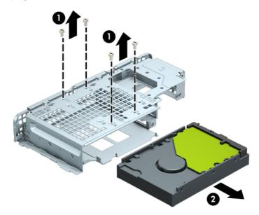
2.5 インチ ハードディスク ドライブを取り外す場合は、ドライブをドライブ ケージに固定 している4本のネジを取り外してから(1)、ドライブを取り外します(2)。
