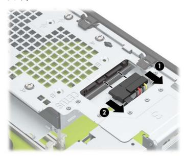
9. ドライブ ケージのリリース ラッチを内側に押して (1)、ドライブ ケージを上方向に回転させて 持ち上げ(2)、ドライブケージの端にあるタブをスライドさせてシャーシから取り外します (3)。
