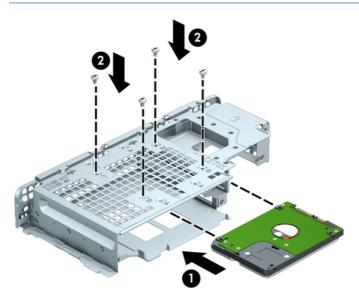
12. ドライブ ケージを傾けたまま、ドライブ ケージの端にあるタブをシャーシのスロットに挿入し ます(1)。カチッという音がしてラッチがシャーシに固定されるまで、ドライブケージのもう一 方の端を下げます(2)。
