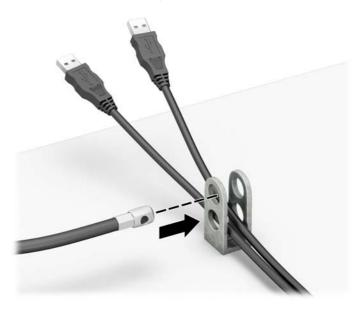
8. 付属のネジを使用して、錠をコンピューター本体に固定します。
