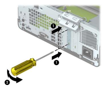
PCI Express x1 カードを取り外す場合は、カードの両端を持ち、コネクタがソケットから抜 けるまで、カードを前後に注意深く軽く揺さぶりながら引き抜きます。拡張カードをソケッ トから引き上げ(1)、拡張スロットカバートレイからカードを取り外します(2)。
