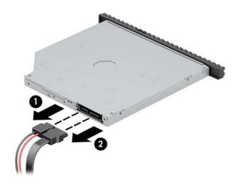
7. ドライブの背面にあるリリースレバーを押し(1)、ドライブをスライドさせてフロントパネル から取り出します(2)。
