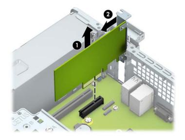
c. PCI Express x16 カードを取り外す場合は、拡張ソケットの後部にある留め具をカードから引 き離し、コネクタがソケットから抜けるまで、カードを前後に注意深く軽く揺さぶりながら 引き抜きます。拡張カードをソケットから真上に引き上げます。
