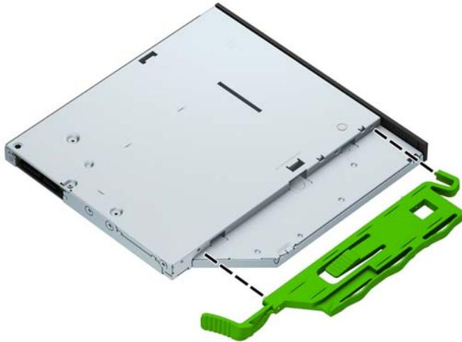
8. 将光驱通过前面板径直推入托架中 (1)，直到其卡入到位 (2)。
