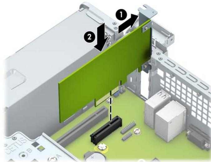
**附註：**安裝擴充卡時，請將卡平穩地下壓，讓整個接頭正確地插入擴充卡插槽內。
