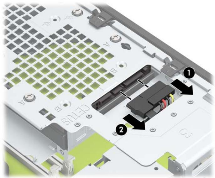
9. 將硬碟機盒釋放門往內壓 (1)，接著將硬碟機盒向上翻轉 (2)，然後再將硬碟機盒側邊的垂片滑出機殼 (3)。
