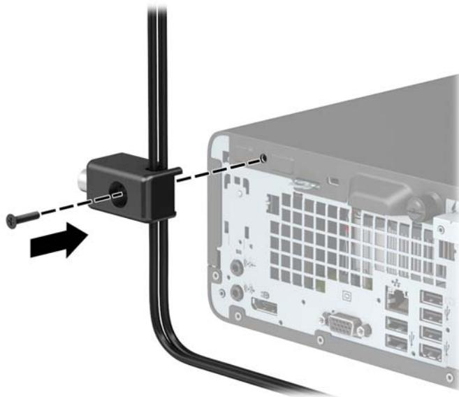
**9.** 將安全纜線尾端的插銷插入鎖中 (1)，並按下按鈕以噏合鎖 (2)。使用提供的鑰匙來解開鉗夾鎖。
