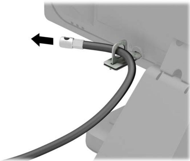
6. 使用適合的螺絲，將配件纜線扣環安裝到桌面上（未隨附螺絲）(1)，然後將配件纜線固定到扣環基座上(2)。
