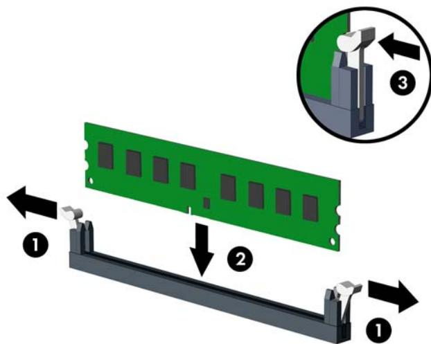
**附註：**記憶體模組僅可用一種方向安裝。請將模組上的凹槽對齊記憶體插槽上的凸耳。
