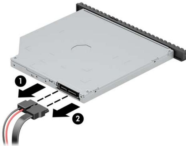
7. 按磁碟機背面的釋放槓桿 (1)，然後將磁碟機滑出前面板 (2)。
