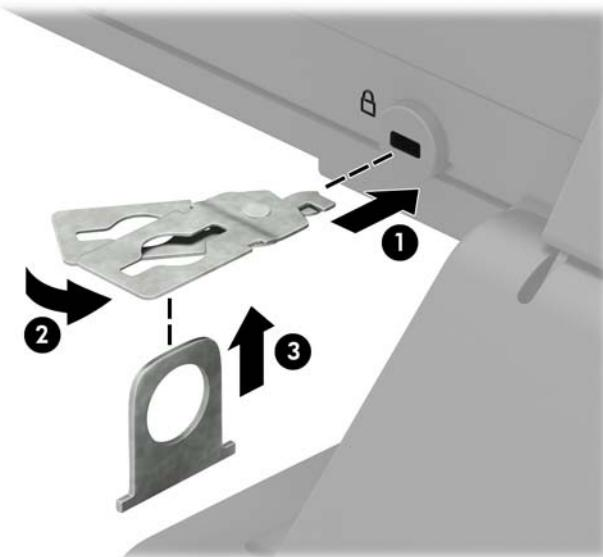
5. 將安全纜線穿過安裝在顯示器上的安全導片。
