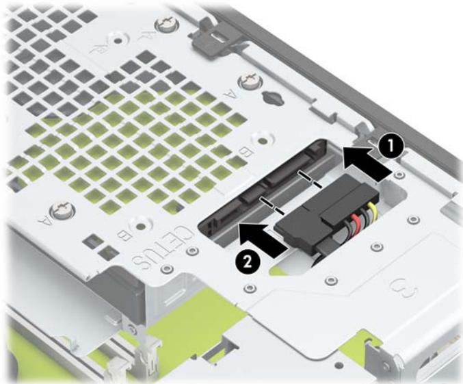
**14.** 將光碟機從正面機殼一路滑進磁碟機插槽 (1)，並鎖至定位 (2)。
