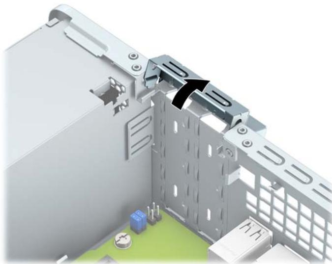
8. Sebelum memasang kartu ekspansi, lepaskan penutup slot ekspansi atau kartu ekspansi yang ada.
