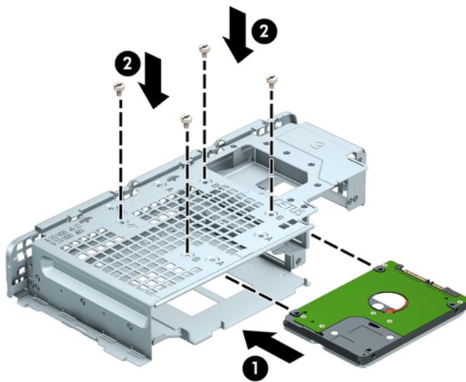
12. Pegang rangka drive menyudut dan masukkan tab bagian sisi rangka drive ke dalam slot pada sasis (1), dan kemudian turunkan bagian sisi lain rangka drive ke bawah agar kait terkunci ke sasis (2).
