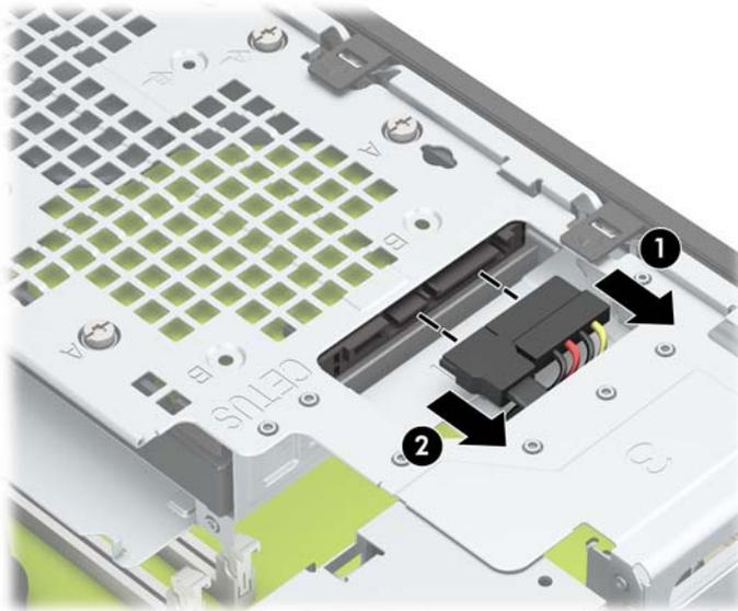
9. Tekan ke dalam kait pelepas rangka drive (1), putar rangka drive ke atas (2), dan kemudian geser tab di bagian sisi rangka drive keluar dari sasis (3).
