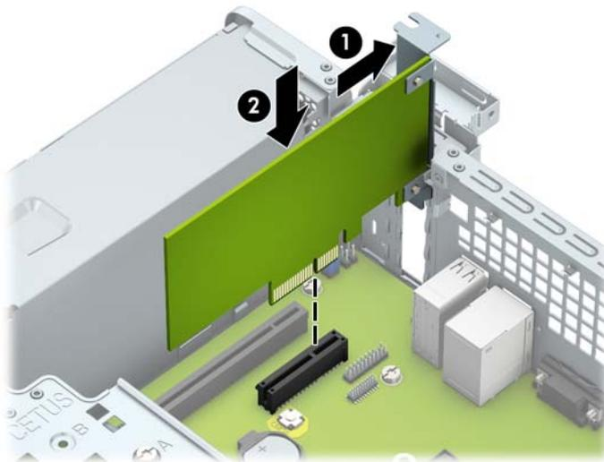
**CATATAN:** Saat memasang kartu ekspansi, tekan kartu dengan kuat agar seluruh konektor terpasang dengan benar dalam soket kartu ekspansi.
