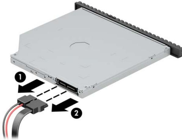
7. Empuje la palanca de liberación situada en la parte trasera de la unidad (1) y luego deslice la unidad a través del panel frontal (2).
