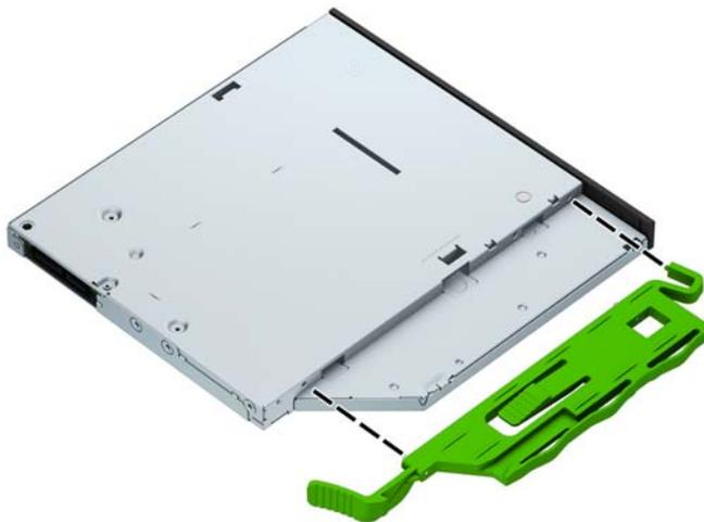
8. Deslice la unidad óptica hasta introducirla en el compartimiento a través del panel frontal (1), de forma que quede encajada en su posición (2).
