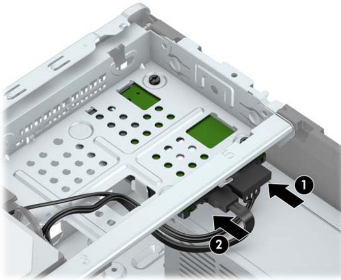
8. Bei der Installation eines neuen Laufwerks verbinden Sie das andere Ende des Datenkabels mit dem entsprechenden Anschluss auf der Systemplatine.
