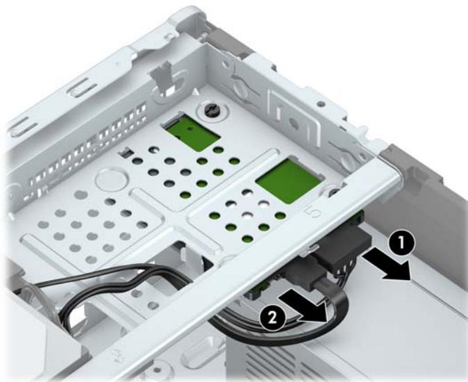
7. Entfernen Sie die drei 6-32-Befestigungsschrauben (1) und schieben Sie die Festplatte aus dem Schacht (2).
