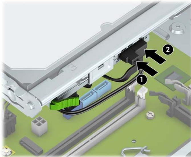
11. Se estiver a instalar uma nova unidade, ligue a extremidade oposta do cabo de dados a um dos conectores SATA azuis-claros (identificados como SATA1 e SATA2) na placa do sistema.
