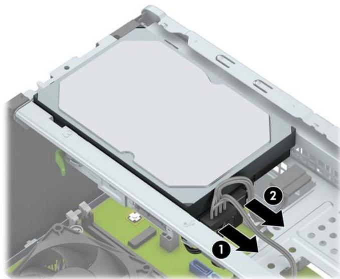
7. Remova os parafusos de montagem (1) e puxe a unidade para cima e para fora do compartimento (2).
