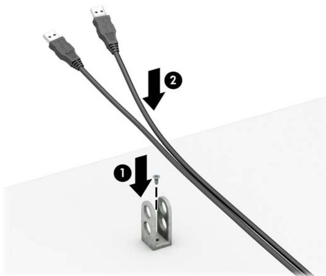
7. Faça deslizar o cabo de segurança através dos orifícios do fixador do cabo dos acessórios.
