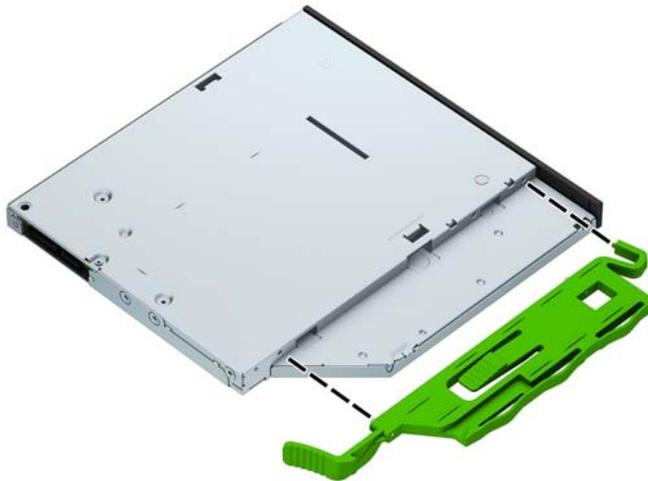
9. Faça deslizar completamente a unidade ótica através do painel frontal (1) de forma que o fecho verde encaixe na estrutura do chassis (2).
