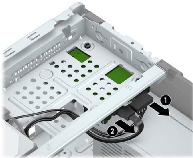
7. Remova os três parafusos de montagem 6-32 (1) e deslize a unidade para fora do compartimento (2).
