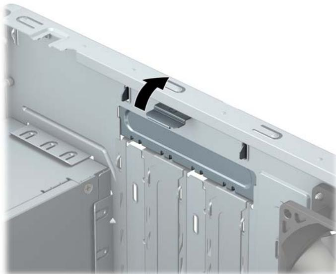
7. Localize a ranhura de expansão vazia correcta na placa de sistema e a ranhura de expansão correspondente na parte de trás do chassis do computador.
