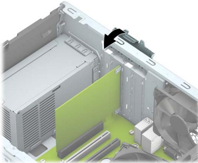
13. Se necessário, ligue os cabos externos à placa instalada. Se necessário, ligue os cabos internos à placa de sistema.
