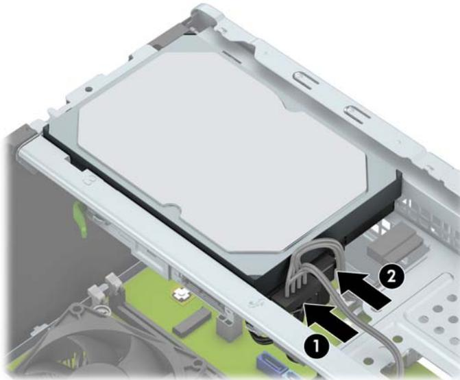
8. Se estiver a instalar uma unidade nova, ligue a extremidade contrária do cabo de dados ao conector adequado da placa de sistema.
