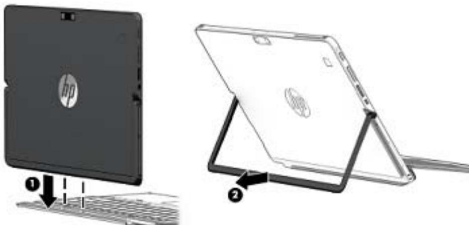
**注記:** キックスタンドを閉じている場合、キーボードを取り付けたまま、コンピューターの背面へキーボードを回転させて、キーボードの背面がコンピューターの背面に接触した状態で固定できます。キーボードがこの位置にある間は、キーボードのキーおよびタッチパッドがロックされ、誤入力防止されます。
