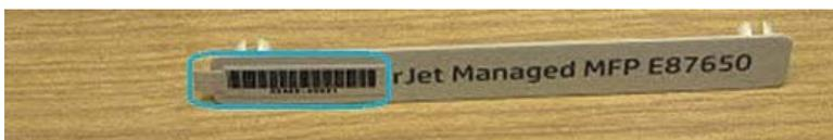
6. Bringen Sie das Namensschild mit der Modellnummer an der vorderen Klappe des Geräts an (rastet ein).
