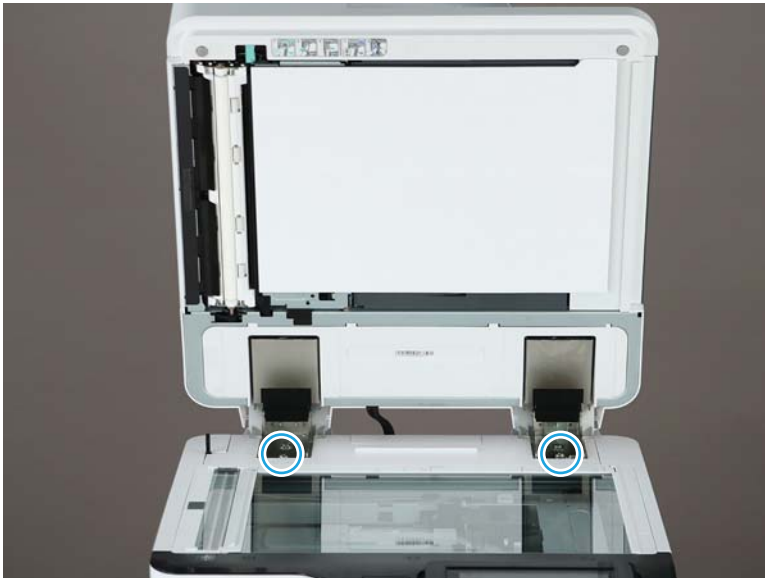
Figura 7-11 Abrir el ADF y soltar los tornillos
