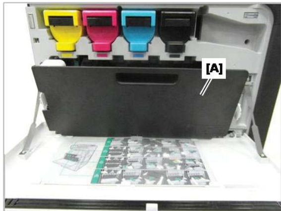
Figura 7-3 Extracción de la unidad de recogida de tóner
