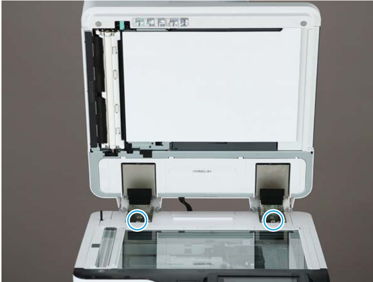
Figura 7-11 Apertura dell'ADF e allentamento delle viti
