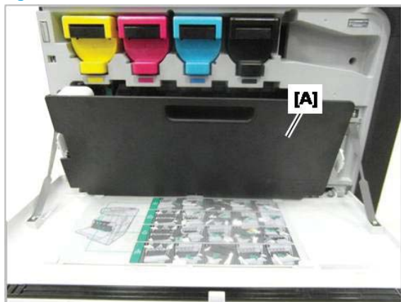
Figura 7-3 Rimuovere l'unità di raccolta del toner
