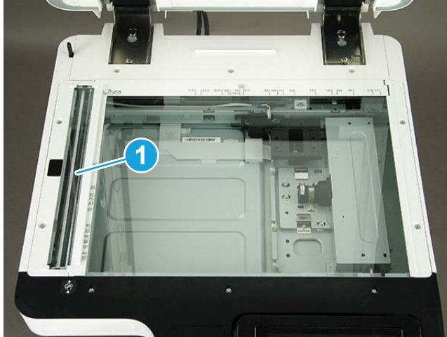
図 7-10 スキャナー ガラスをクリーニングする
