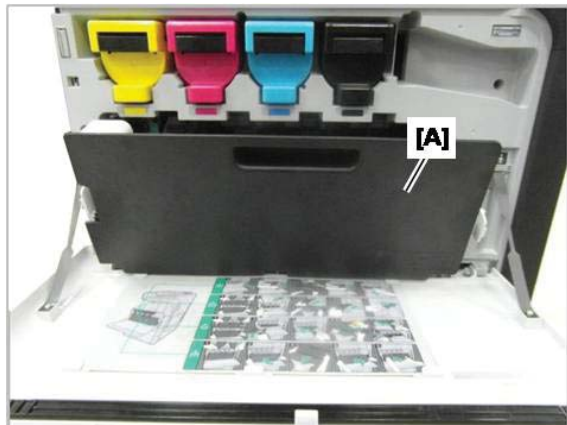
図 7-3 トナー回収ユニットの取り外し
