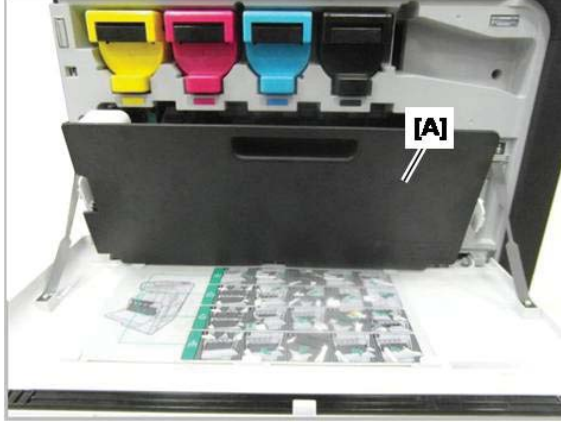
Şekil 7-3 Toner toplama birimini çıkarın
