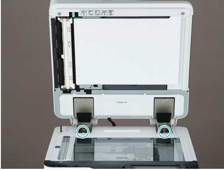
Şekil 7-11 ADF'yi açın ve vidaları gevşetin
