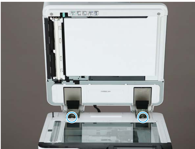
图 7-11 打开 ADF 并拧松螺钉
