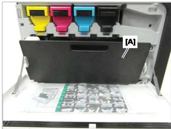
图 7-3 卸下碳粉收集装置
