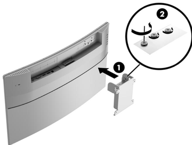
3. VESA 準拠の取り付け器具に付属している 4 つのネジを使用して、マウント プレートを所定の壁またはスイングアームに固定します。
