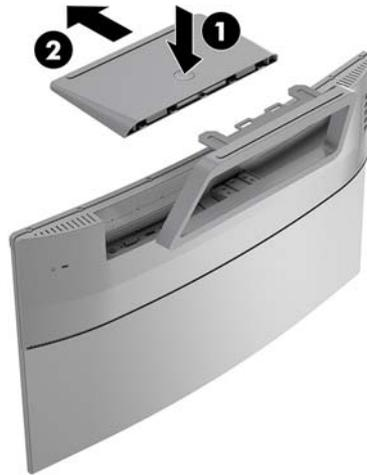
3. スタンドを手で押さえて、スタンドをモニターに固定しているネジを取り外します (1)。次に、スタンドを持ち上げてモニターから取り外します (2)。
