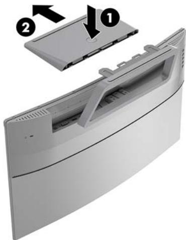
3. 按住底座并卸下将底座固定在显示器上的螺钉 (1)。然后向上提起底座，使其脱离显示器 (2)。
