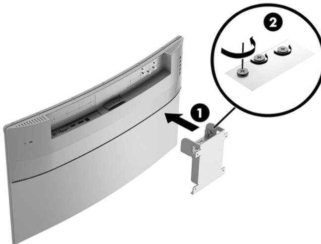
3. Kencangkan pelat pemasangan ke dinding atau lengan ayun pilihan Anda menggunakan keempat sekrup yang disertakan bersama braket pemasangan VESA.
