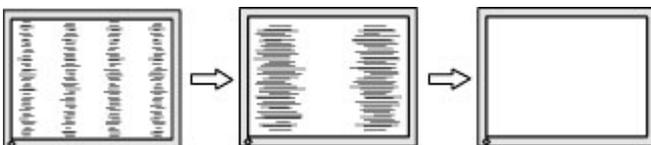
3. Después de ajustar el Reloj, si aparece borrosidad, movimiento rápido o barras en pantalla, continúe para ajustar la Fase.
