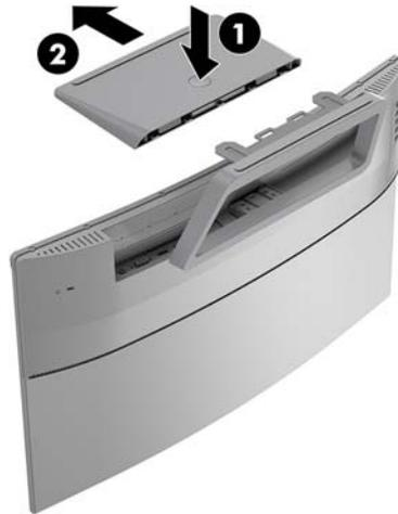
3. Sostenga el soporte y retire los tornillos (1) que fijan el soporte al monitor. A continuación, levante el soporte para sacarlo del monitor (2).
