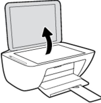
2. Chargez l'original, face à imprimer vers le bas, sur l'angle avant droit de la vitre du scanner.
