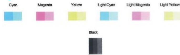
Figura 8-2 Esempi di blocchi di colore con difetti
