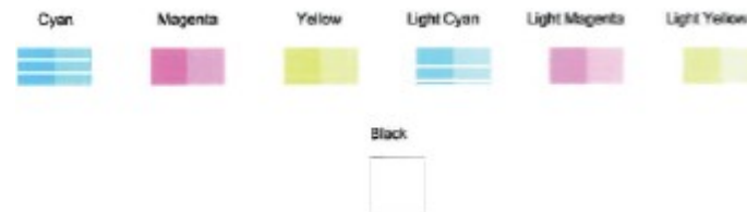
Figura 8-2 Esempi di blocchi di colore con difetti
