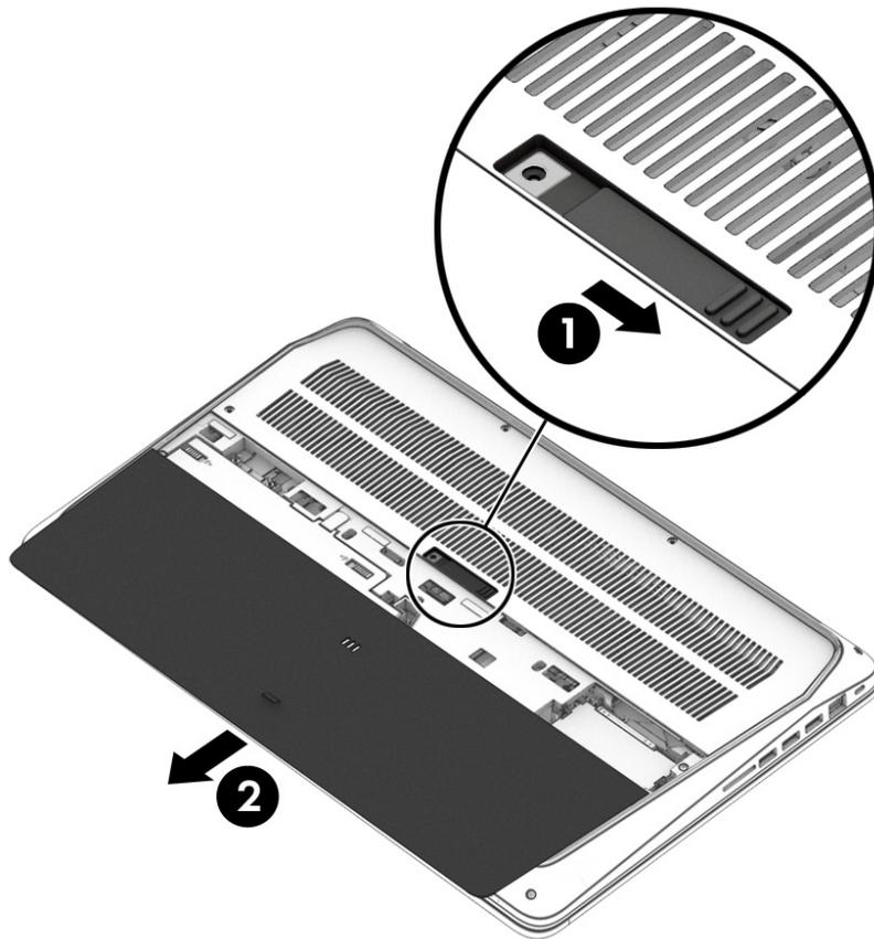
3. Faites glisser le loquet de dégagement de la batterie (3), puis tirez le taquet de la batterie vers l'extérieur (4) pour extraire la batterie de l'ordinateur.
