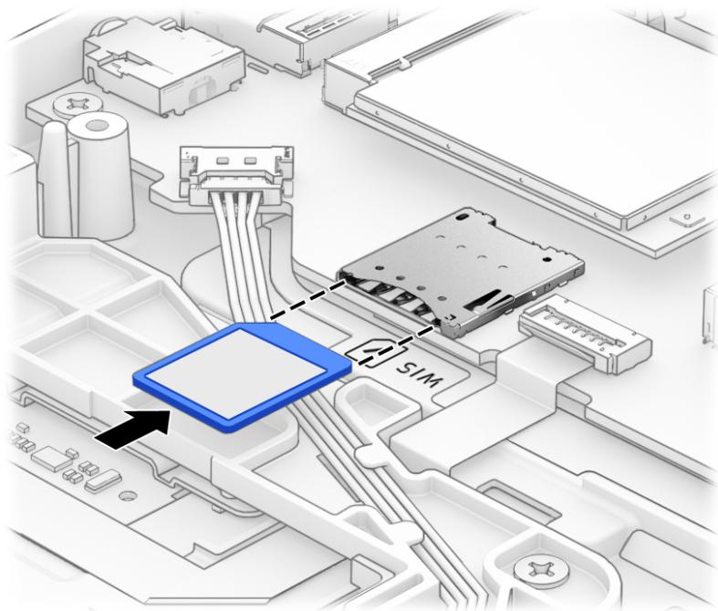
SIM カードを取り出すには、SIM カードをいったんスロットに押し込んで、固定を解除してから引き抜きます。
